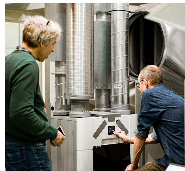
Tests des performances acoustiques de l'unité Zehnder ComfoAir Q
